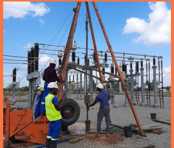
Execução de ensaios de penetração dinâmica com a sonda normalizada "SPT-Terzaghi"
