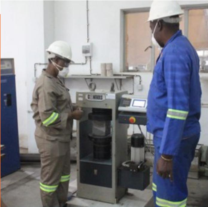
**Determinação da resistência à Compressão de provetes de Betão**
