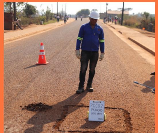
**Ensaio de controle de densidade e o teor de humidade**
