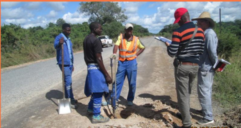
**Ensaio de DCP ( determina a resistência do solo quanto a penetração)**
