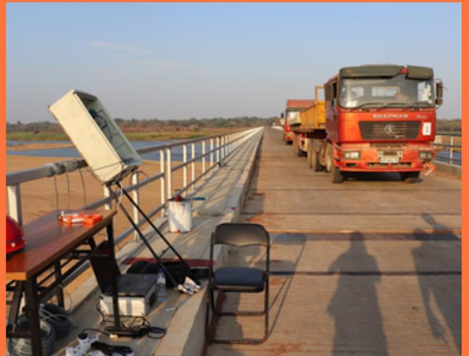
Ensaio de Carga na Ponte de Malei
